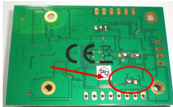
Die Standardeinstellung ist „Versorgungsspannung“, der Lötjumper liegt auf den beiden rechten Pads. Um auf die Einstellung „TTL“ umzustellen, muss der Lötjumper auf die beiden linken Pads umgelötet werden.
