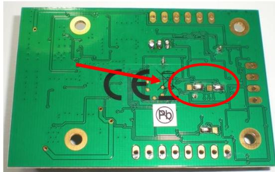
Sind die Lötjumper dem 4-Poligen Anschluss zugewandt, so ist die Sonde vom Typ Bosch LSU4.2 ausgewählt:
